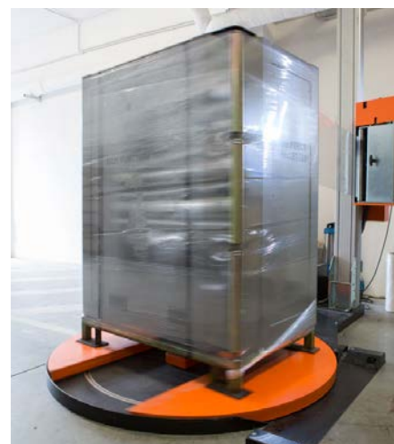
Abbildung 2: Testsystem zur Überprüfung der Lagenhaftung an der Palette
